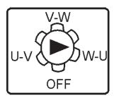
Figure 17. AC Voltmeter Change-Over Switch
